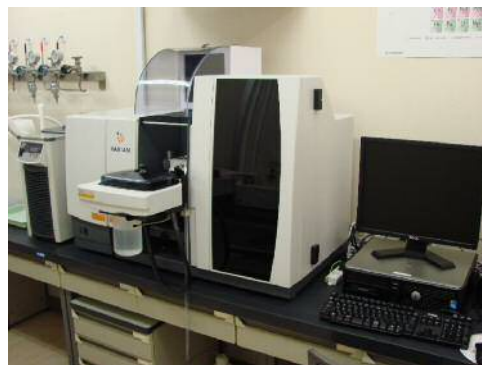
原子吸光分光光度計 (分析対象項目：金属類)
